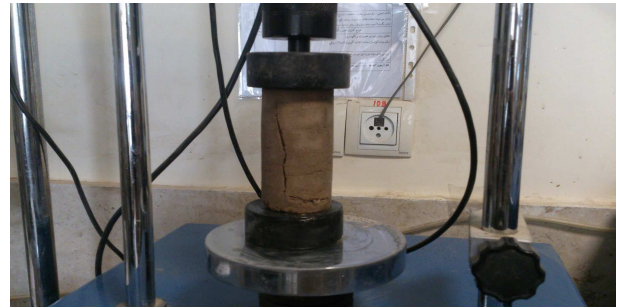
شکل ۳. نمونه‌ی گسیخته شده در دستگاه تک‌محوری با افزودن ۲٪ نانوسیلیس.
