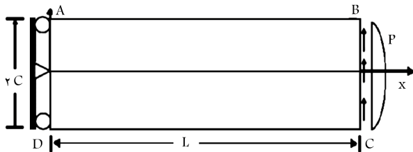
شکل ۳. شرایط حاکم بر تیر طره تحت نیرو با توزیع سهمی‌گون در انتهای آزاد.
