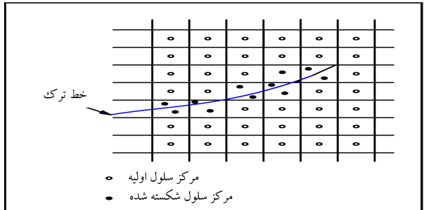
شکل ۲. شبکه‌ی سلولی استفاده شده برای گسسته‌سازی میان صفحه‌ی ورق ترک خورده در روش حجم محدود.
