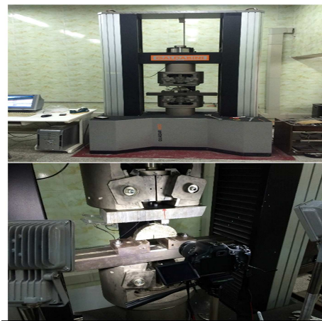
شکل ۵. نمایی از چگونگی قرارگیری نمونه‌ی نیم‌دیسک با ترک در دستگاه یونیورسال.
