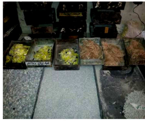
الف) نمایی از مصالح سنگی و الیاف طبیعی و ب) اختلاط برای تهیه ی آسفالت نیمه گرم؛ مصنوعی مورد استفاده برای ساخت نمونه ها؛
