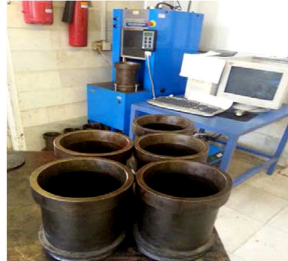
پ) تهیه ی نمونه های آستوانه یی شکل به قطر ۱۵ cm به روش تراکم چرخشی؛
