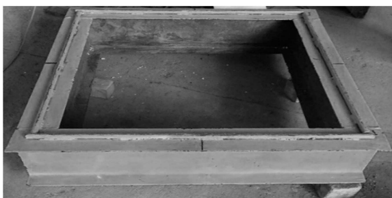
شکل ۳. قاب فولادی استفاده شده به‌عنوان تکیه‌گاه دال.
