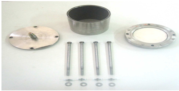
شکل ۳. اجزاء و قطعات دستگاه صفحه‌ی فشاری.
