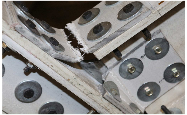
شکل ۱۳. لحظه‌ی شکست اتصال پیچی.
