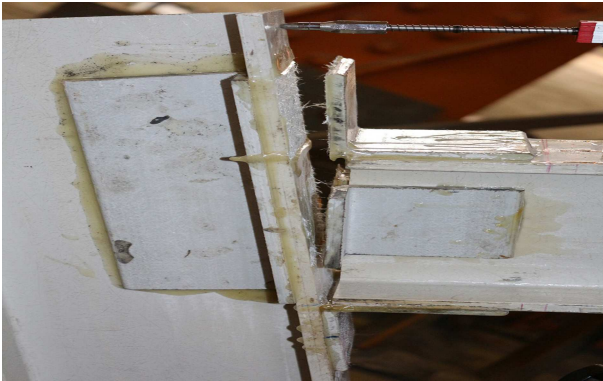
شکل ۱۹. لحظه‌ی شکست در اتصال چسبی.
