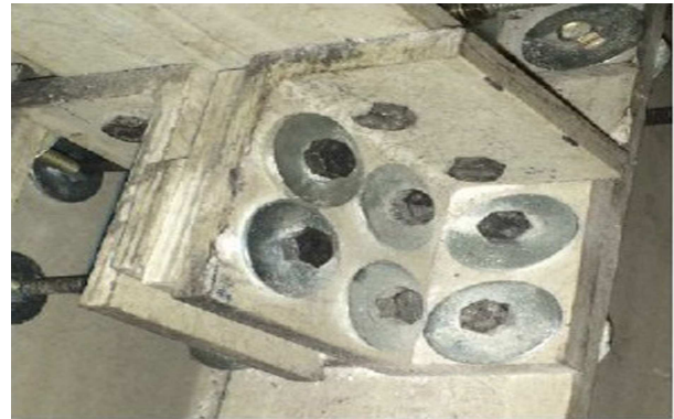
شکل ۲. نبشی‌های تقویت شده‌ی مورد بررسی.
