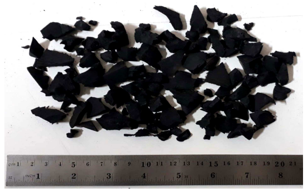
شکل ۲. خرده‌لاستیک دانه‌یی مورد استفاده در آزمایش‌ها.
