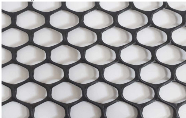
شکل ۳. ژئوگرید مورد استفاده در آزمایش‌ها.
