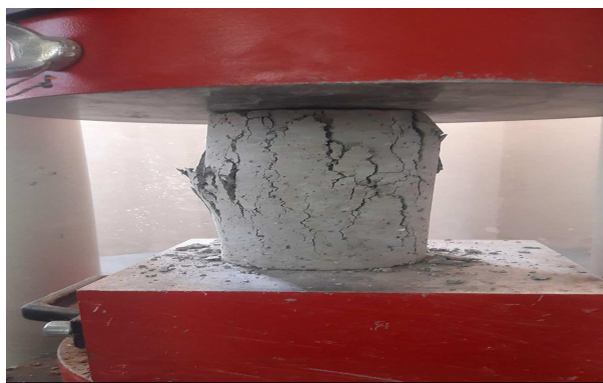
شکل ۳. آزمایش مقاومت فشاری نمونه‌ها.
