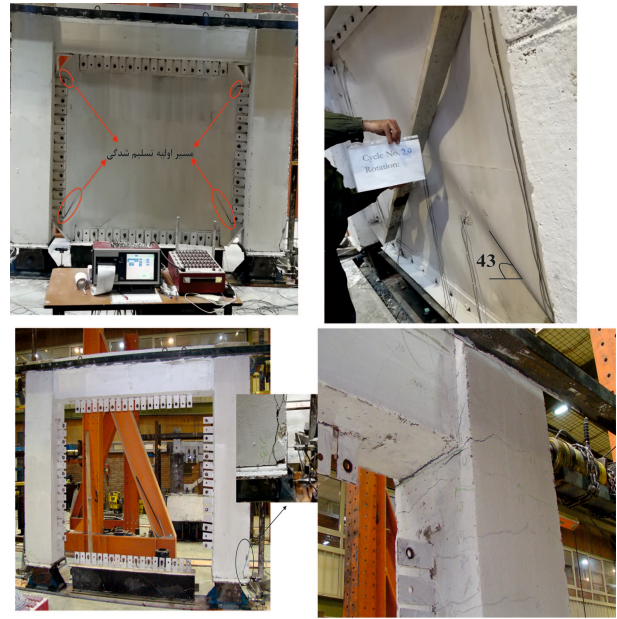
شکل ۸. عملکرد و شکست نمونه‌های SPSWS و MBF.
