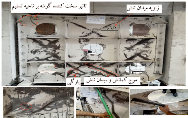
شکل ۷. رفتار و نحوه‌ی شکست نمونه‌ی دارای بازشو و سخت‌کننده.
