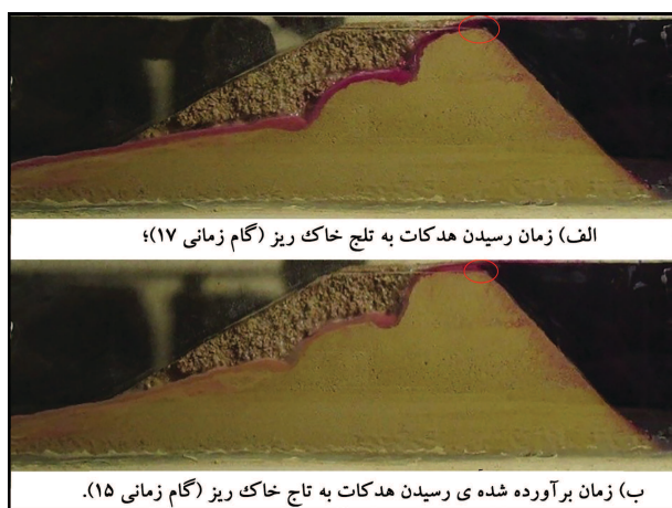
شکل ۱۵. وضعیت خاکریز هنگام رسیدن پدیده بدون سر الف) زمان برآورده شده، ب) از رسیدن آن به تاج خاکریز با درصد تراکم ۹۵٪.
