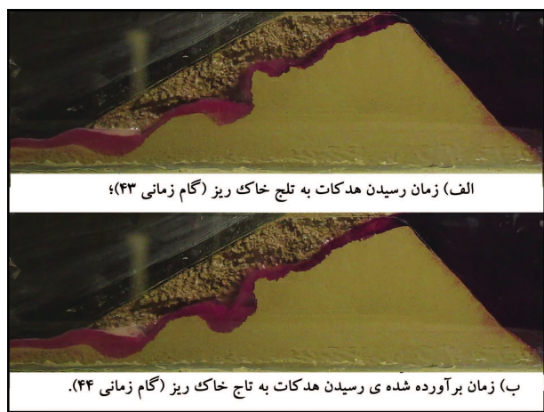
شکل ۱۷. وضعیت خاک ریز هنگام رسیدن پدیده بدون سر الف) زمان برآورده شده، ب) از رسیدن آن به تاج خاک ریز با درصد تراکم 105\% .
