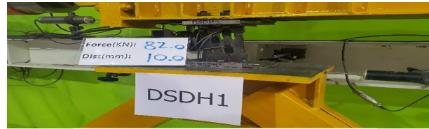
الف) تغییر شکل نمونه ۱ DSDH در موقعیت بیشینه نیرو
