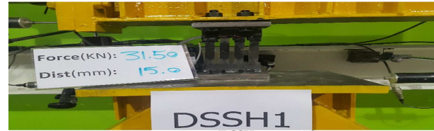
ب) تغییر شکل نمونه ۱ DSSH در موقعیت بیشینه نیرو.
