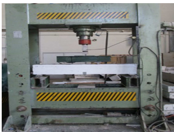
شکل ۱۱. دستگاه بارگذاری و نحوه‌ی بارگذاری نمونه‌ها.
