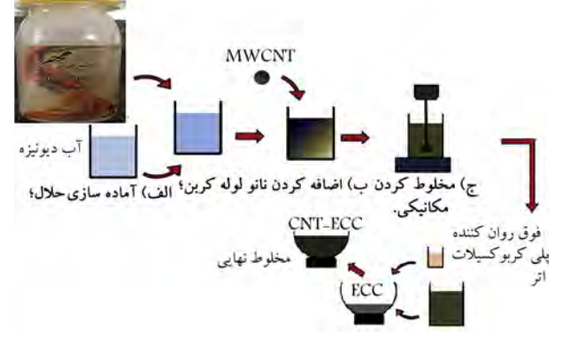
شکل ۳. فرایند مخلوط کردن و آماده‌سازی نانولوله‌های کربن.
