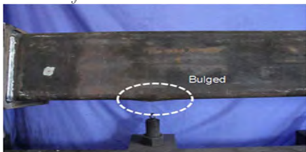
الف) خمیدگی ورق انتهایی؛
