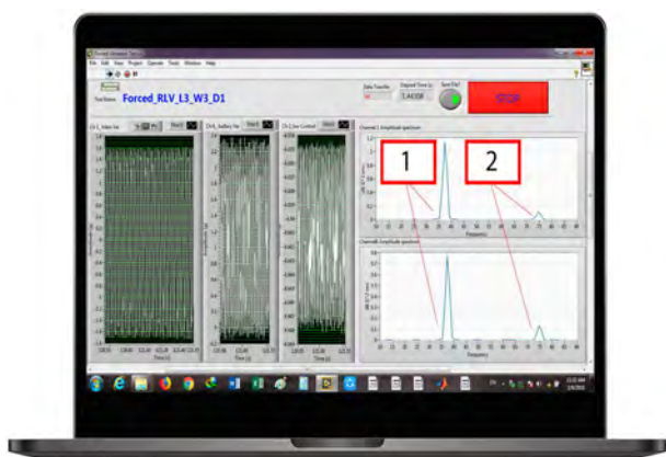
شکل ۸. نمونه‌یی از صفحه‌ی نرم‌افزار طراحی شده: (۱) بسامدهای غالب (بسامد ارتعاش)، (۲) نویز و سایر مودهای موجود و میزان تأثیرگذاری آن‌ها.
