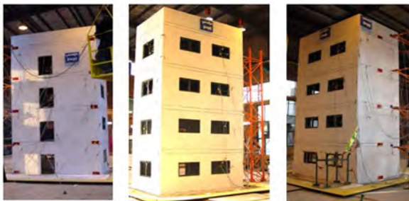
شکل ۴. نماهای کلی ساختمان در مجموعه‌ی آزمایشگاهی میز لرزان. [۲۴]
