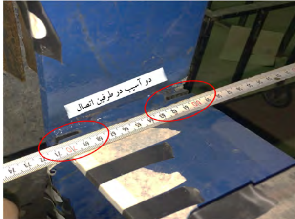
شکل ۸. نمونه‌یی از اتصال آسیب دیده در مدل آزمایشگاهی.
