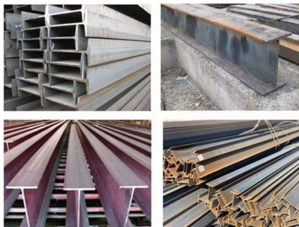
شکل ۱. مقاطع IPE، INP و تیرورق‌های فولادی با جان سخت‌نشده.
