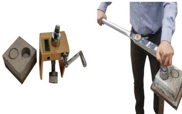
شکل ۲. اندازه‌گیری مقاومت چسبندگی برشی و کششی.
