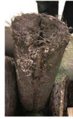
ب) نمونه دارای الیاف پس از آزمایش دو نیم شدگی؛
