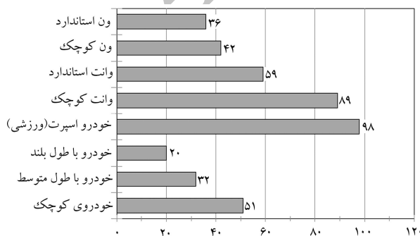
شکل ۱. میانگین مرگ‌ومیر سالانه بر اثر بیش‌غلته برای یک میلیون خودرو ثبت‌شده براساس اطلاعات FARS سال‌های ۱۹۹۱-۱۹۹۸. [۲]
