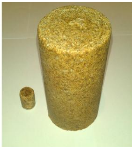
شکل ۴. نمونه‌های بزرگ و کوچک آزمایش فشاری بتن پلیمری.
