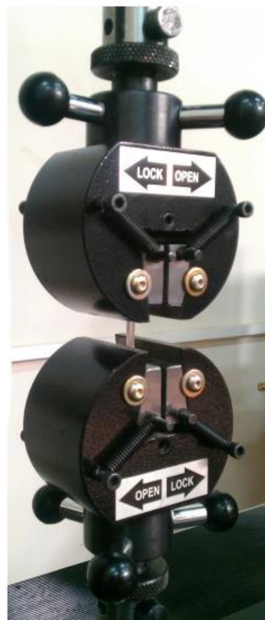
شکل ۶. نحوه‌ی قرارگیری نمونه‌ی کششی کوچک رزین پلی استر در دستگاه آزمایش.
