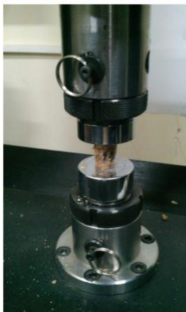
شکل ۱۴. نحوه قرارگیری نمونه فشاری کوچک بتن پلیمری در دستگاه آزمایش.
