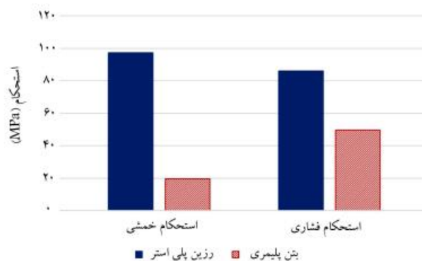
شکل ۲۱. مقایسه‌ی استحکام خمشی و فشاری رزین پلی استر و بتن پلیمری در نرخ کرنش شبه استاتیکی.
