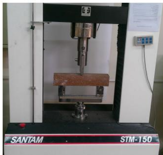
شکل ۱۸. نمونه‌ی خمش سه نقطه‌ای بتن پلیمری به هنگام آزمایش.
