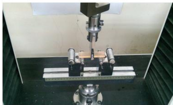
شکل ۱۱. نمونه‌ی خمش سه نقطه‌ای رزین پلی استر به هنگام آزمایش.
