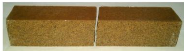
شکل ۲۰. سطح شکست در نمونه‌ی بتن پلیمری که تحت بار خمشی قرار گرفته است.
