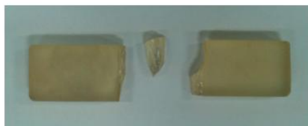
شکل ۱۳. یک نمونه خمش سه نقطه‌ای رزین پلی استر بعد از انجام آزمایش.
