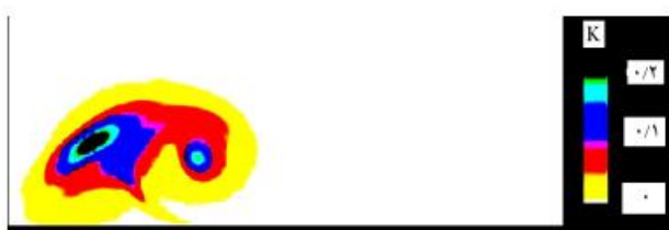
شکل ۱۱. انرژی جنبشی نوسانی گردابه در صفحه‌ی عمود بر یک نمونه بال دلتای 50^\circ درجه در زاویه‌ی حمله 15^\circ درجه. [۵]
