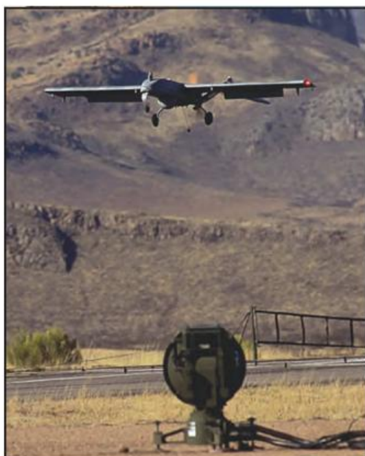
شکل ۳. سیستم فرود خودکار تاکتیکی (TALS).
