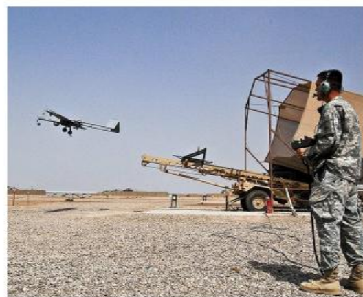
شکل ۶. برخاستن پهپاد Shadow به‌کمک لانچر.
