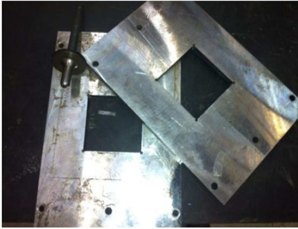
شکل ۳. قاب نگه دارنده‌ی نمونه‌ها و شکل نفوذکننده‌ی کروی.
