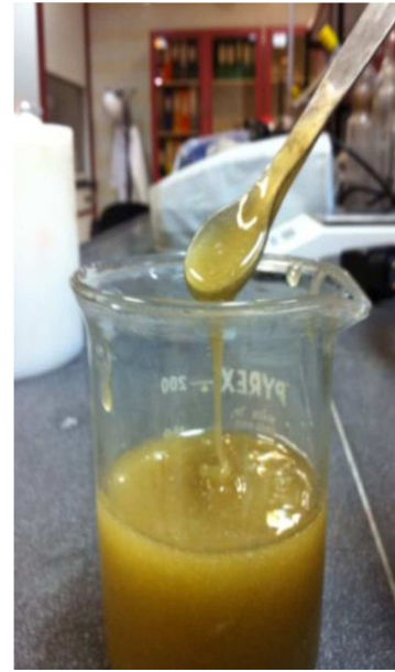
شکل ۲. سیال سخت‌شونده با حضور نانوذرات خاک رس.
