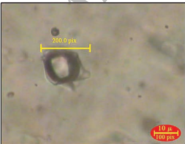
شکل ۱۲- تصاویری از سیالات گروه C که از دو فاز گاز و مایع (با حجم بیشتر گاز) تشکیل شده‌اند. تصاویر از نمونه Tf3a
