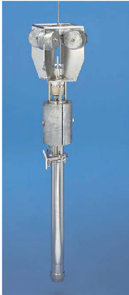
شکل ۲- دستگاه مغزه‌گیر ثقلی استفاده شده در این مطالعه
