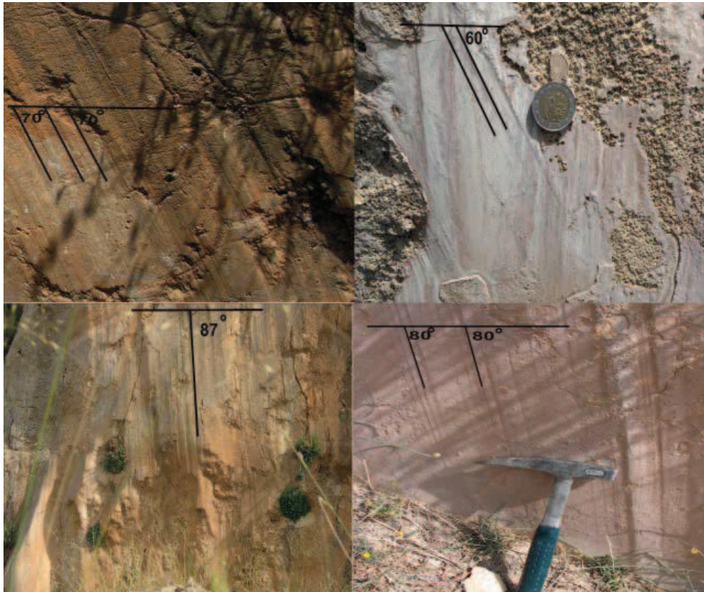
شکل ۵. خش لغزهای برداشت شده از آینه گسلی ارژن باختری (جهت دید ناظر رو به شمال باختر).
