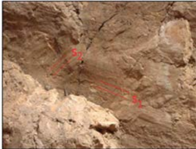
شکل ۳. توالی دو رویداد زمین‌ساختی بر روی یک صفحه گسلی، نسل خط‌خس قدیمی با S_1 و جوان‌تر با S_2 نشان داده شده است.
