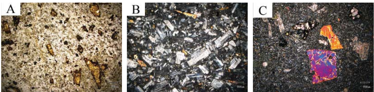
شکل ۵. تصویر میکروسکوپی از نمونه‌های سنگی: (A) آندزیتی - آمفیبول‌های اپاسیتی شده، (B) دیوریت پورفیری، (C) آندزیت بازالت - حضور الیوین‌های ایدنگیزیته شده و پیروکسن به صورت فنوکریست در زمینه‌ای از میکروولیت‌های پلاژیوکلاز Xpl.
