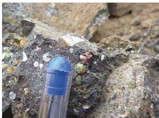
شکل ۱۷. پر شده گی حفرات آندزیت توسط مس خالص
