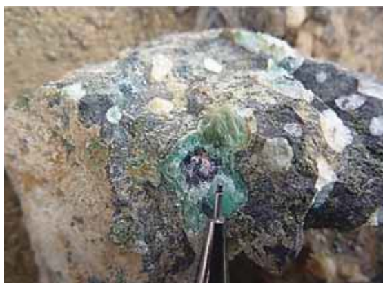
شکل ۱۷. پر شده گی حفرات آندزیت توسط مس خالص
