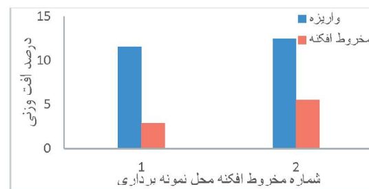
شکل ۱۴. اختلاف بین میزان افت وزنی ناشی از ۱۰ سیکل یخزدگی-آبشستگی سنگ‌دانه‌های تجمع یافته در مخروط‌افکنه‌ها و واریزه‌های واقع در حوضه بالادست آن (۱۶-۱۲/۵ mm)
