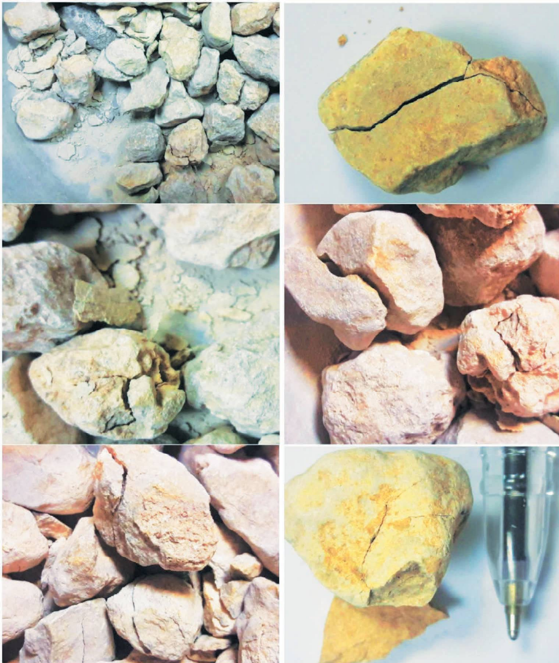
شکل ۷. نمونه‌هایی از تخریب سنگ‌دانه‌ها به علت سیکل‌های یخ‌زدگی-آب‌شدگی
