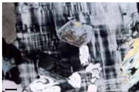
شکل ۶. دگرسانی فلدسپاتها به سرسیت و کائولینیت - XPL
