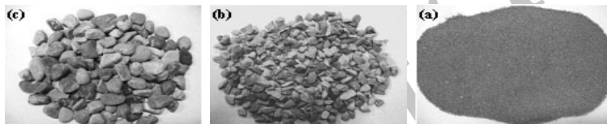
شکل ۱. مصالح مصرفی در این تحقیق (a) ماسه (b) شن تیزگوشه (c) شن گردگوشه
