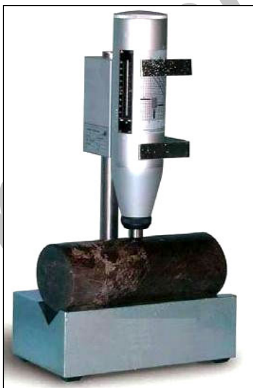
شکل ۱. نحوه استفاده از چکش اشمیت
