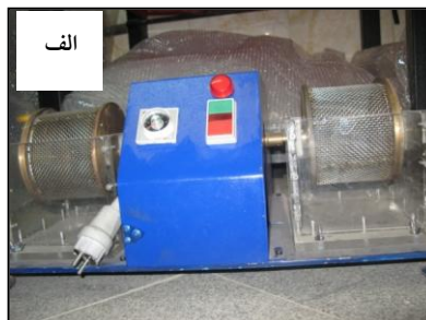
شکل ۱. الف) دستگاه آزمایش دوام استاندارد [۶]، ب) تعدادی از نمونه‌های تهیه شده برای آزمایش
