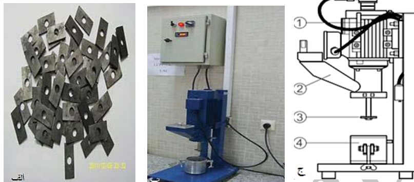
شکل ۵. مجموعه تجهیزات آزمایش LCPC با پروانه آن [۱۰]
