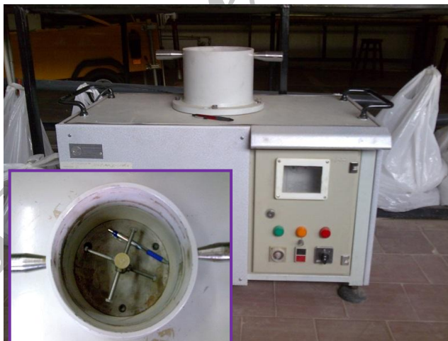
شکل ۷. دستگاه سایش اصلاح شده با سنچش‌گر پیچ آهنی به جای دیسک (دستگاه FUAT)
