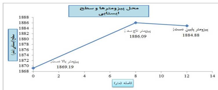
شکل ۷. رفتار نامتعارف مشاهده‌های پیزومتریک در بخشی از سد
