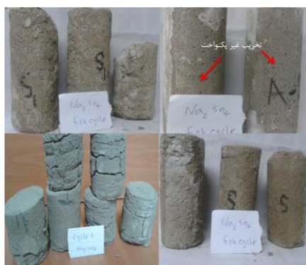
شکل ۸. تخریب نوع اول: تخریب دانه‌ای (granular disintegration) و تخریب پوست پیازی (جدا شدن سطوح نازک بیرونی از نمونه‌های سنگی)
