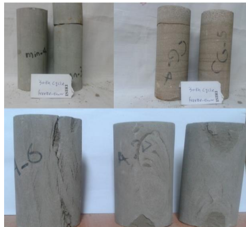
شکل ۶. تخریب نوع اول: تخریب نمونه‌های ماسه سنگی در امتداد سطوح ضعف از پیش موجود و لامینه‌ها (قطر نمونه‌ها ۵/۴ سانتی‌متر و طول آن‌ها ۱۴ سانتی‌متر است)
