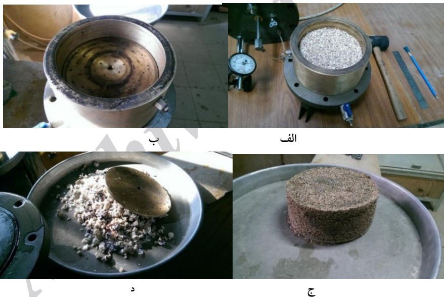
شکل ۲. الف) ساخت نمونه، ب) نمونه بارگذاری شده، ج و د) نمونه‌های خارج‌شده از داخل قالب
