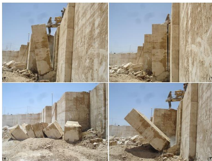
شکل ۳. مراحل استخراج یک بلوک سنگ (دارای لایه‌بندی ظریف) در یکی از معادن تراورتن مجتمع معدنی حاجی‌آباد محلات
