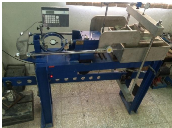
شکل ۲. نمای کلی از دستگاه برش مستقیم بزرگ مقیاس جدول ۲. برنامه آزمایش‌ها
