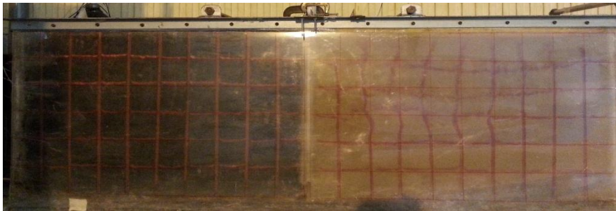
شکل ۱۱. تغییر شکل مدل بعد از بارگذاری برای تست d TC_r = 20\%
