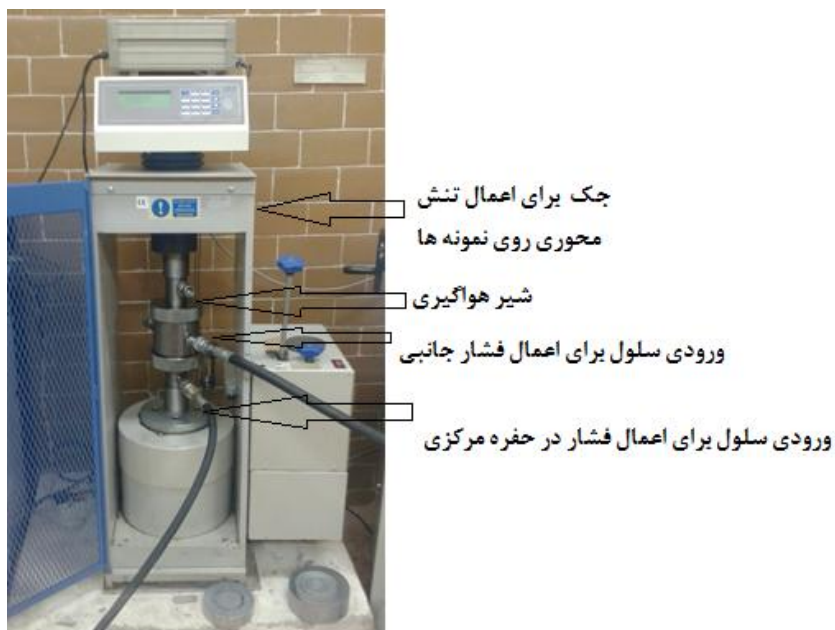
شکل ۴. دستگاه آزمایش در هنگام یکی از آزمایش‌های شکست هیدرولیکی
