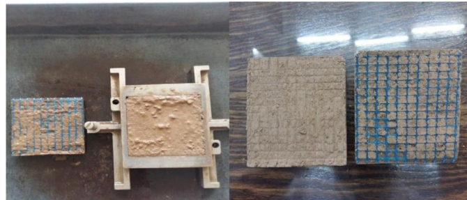
شکل ۱۹. نمونه‌های مسلح‌شده پس از انجام آزمایش (سمت راست: در درصد رطوبت بهینه و سمت چپ: در درصد رطوبت بیش‌تر از بهینه)
