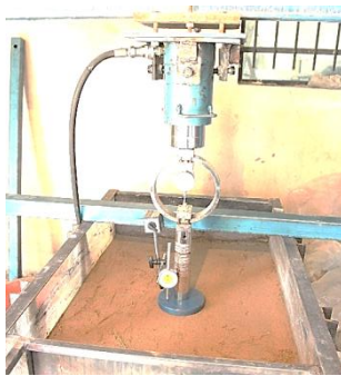
شکل ۵. ابعاد کلی مدل آزمایشگاهی، موقعیت قرارگیری لایه‌های خاکریزی و صفحه بارگذاری
