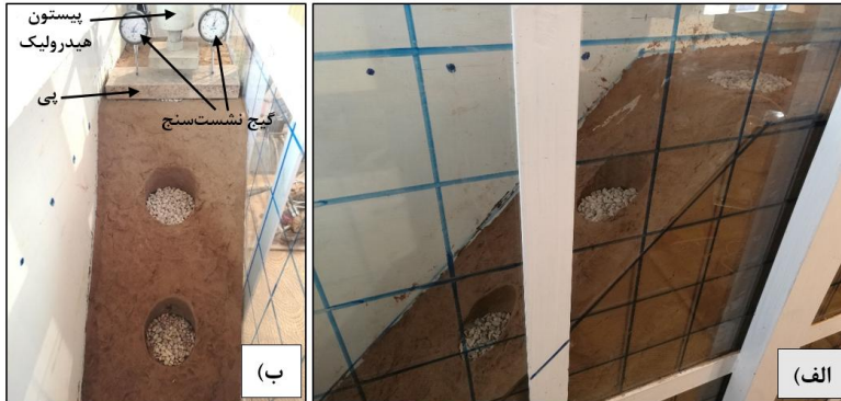
شکل ۱۳. نحوه اجرای گروه سه ستون سنگی غیرمسلح: الف) سه ستون اجراشده قبل از قرار دادن پی، ب) ستون‌های اجراشده پس از قرارگیری پی نواری و گیج‌های نشست‌سنج فشار (کیلوپاسکال)
