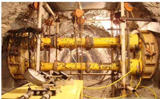
شکل ۵. نمایی از آزمون بارگذاری صفحه‌ای به صورت افقی در گالری RG3 [۳۹]
