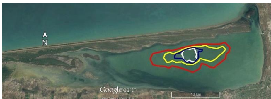
شکل (۲): تغییرات هندسی خلیج گرگان متاثر از مجموعه عوامل در نظر گرفته شده در هر سناریو (منحنی قرمز سناریو ۲، منحنی زرد سناریو ۵، منحنی آبی سناریو ۴ و منحنی سفید سناریو ۳ می‌باشد)
